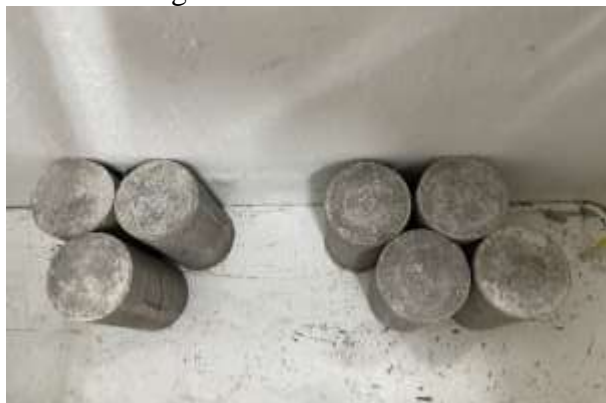
Figura 7 - CPs Submetidos à congelamento no freezer
