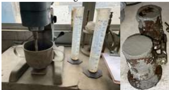
Figura 5 - Preparação de traço e moldagem de CPs.
