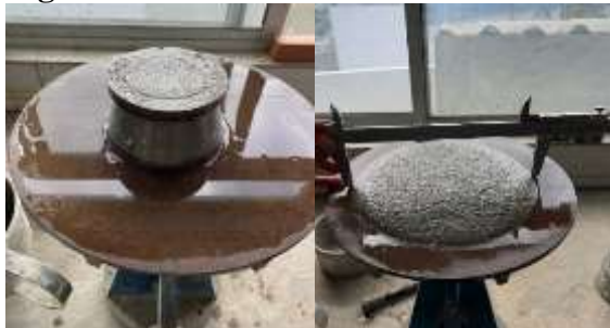
Figura 4 - Ensaio de Índice de Consistência.
