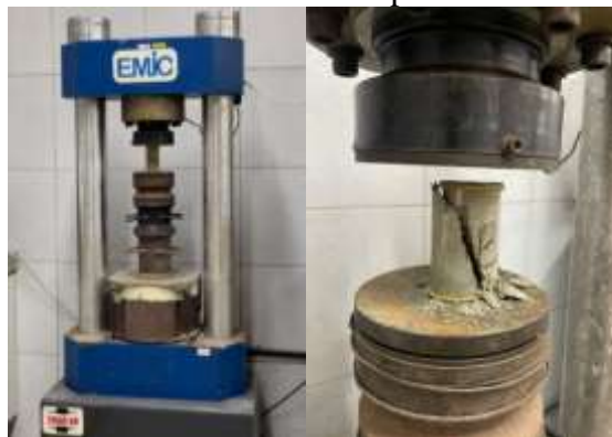
Figura 6 - Ensaio de Determinação da Resistência à Compressão.
