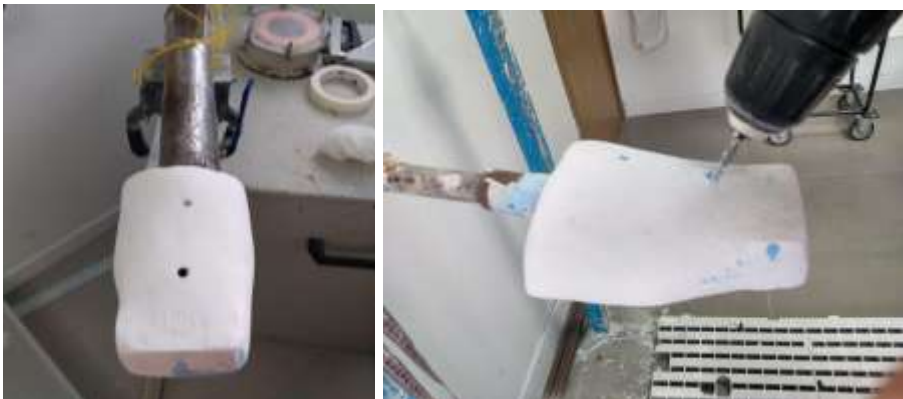
Figura 2 - Preparação do molde positivo do dispositivo para o processo de termo moldagem
