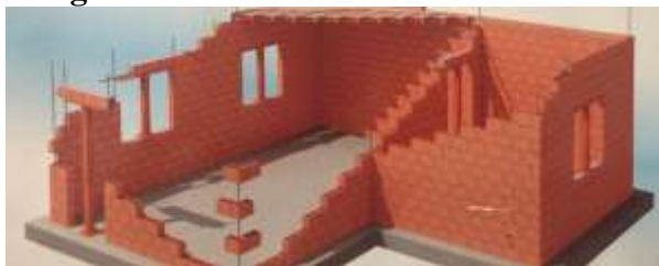
Figura 5 – Parede de Alvenaria estrutural
