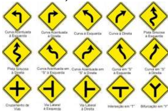
Figura 3 Sinalização de Advertência
